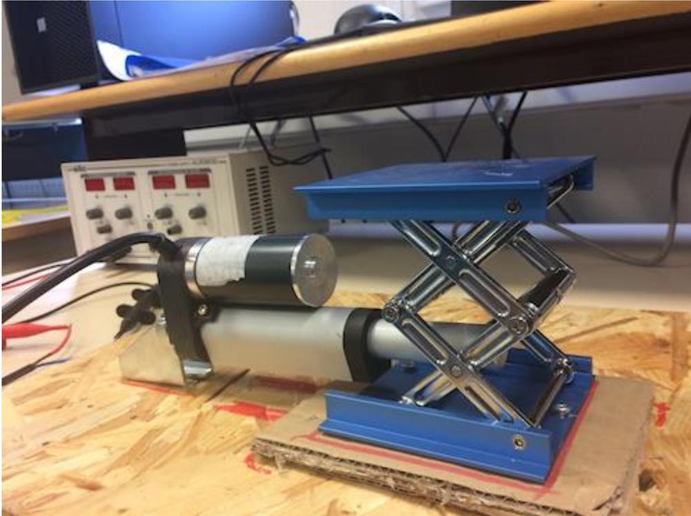
Système d'adaptation de la hauteur de l'assise d'un fauteuil roulant au mobilier.
